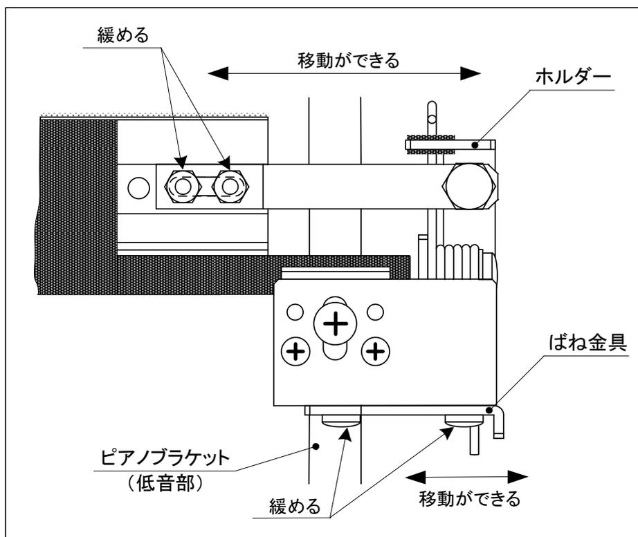
図3.2-7 ホルダーとばね金具の移動
