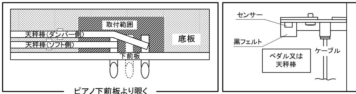
図3.4-1 ペダルユニットの取り付け
