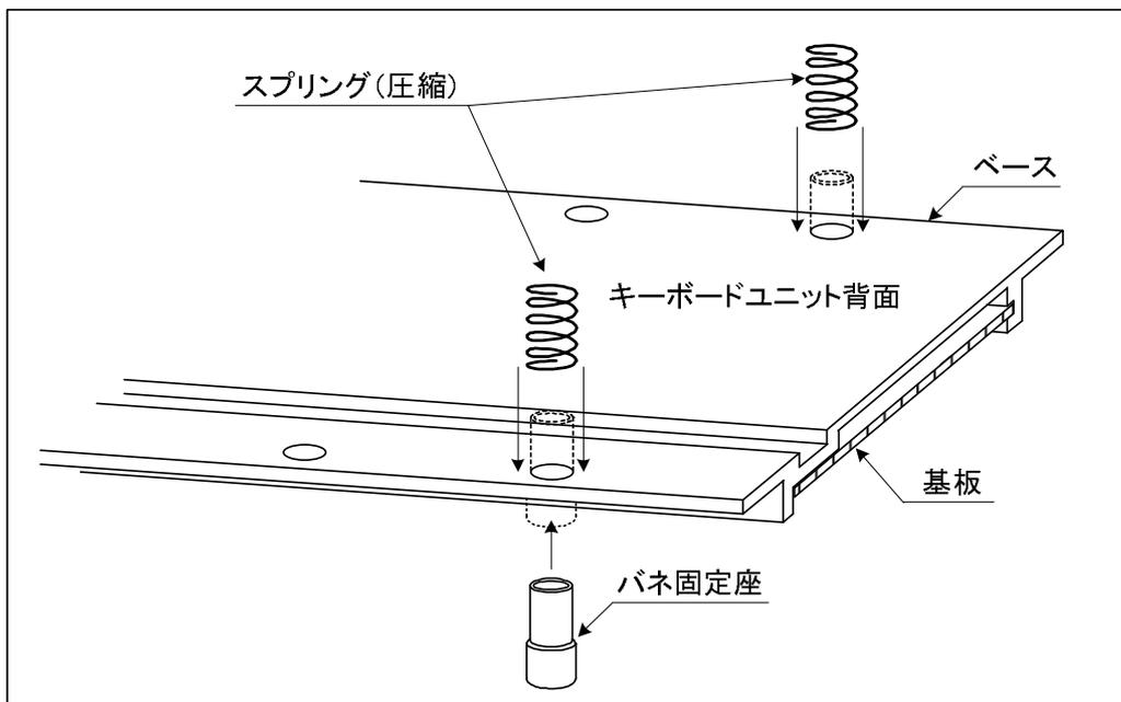
図3.3-2 スプリング（圧縮）取り付け
