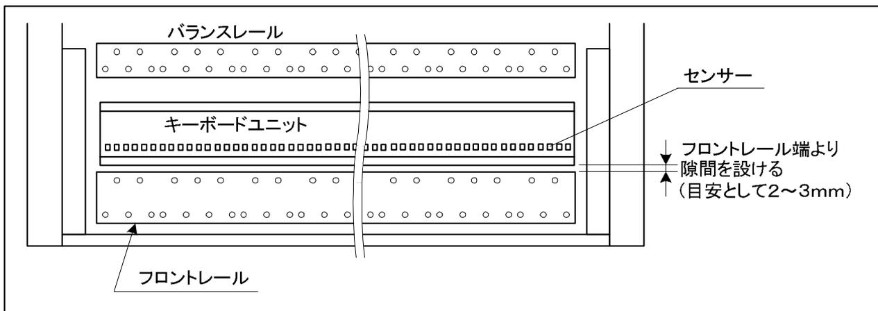
図3.3-3 キーボードユニットの取り付け
