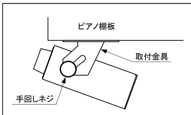
図 3. 6 - 3 音源BOXの角度調整
